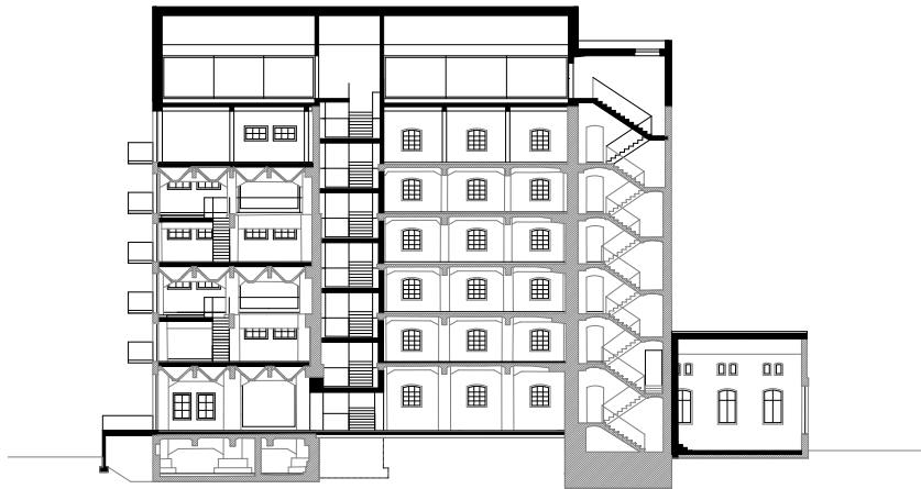
Längsschnitt (BT2 links des Treppenhauses) M 1:500
